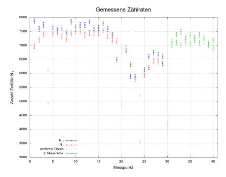
Man erkennt, dass bei längerem Betrieb des Magneten die Zählrate deutlich abnimmt, was auf die Erwärmung des Magneten und Hysterese-Effekte zurückzuführen ist, so dass wir nach den 30 Messungen den Magenten abkühlen ließen und weitere 10 Messungen durchführten. Diese liegen wieder ungefähr auf dem Niveau der ersten Messungen.
