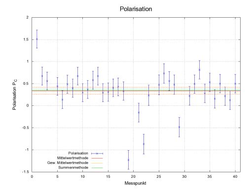
Um aus den Werten für die zirkulare Polarisation  $P_c$  der Photonen auf die Helizität H der Elektronen zu schließen, muss man den Helizitätsübertrag L abschätzen. Dieser wird mit Hilfe des Diagramms aus dem "blauen Buch" [1] bestimmt. Wir schätzen einen Wert von  $L=0, 8\pm 0, 1$ . Die Helizität H, ihr statistischen Fehler  $\sigma_H$  und systematischer Fehler  $\Delta H$  werden mit diesen Formel berechnet:
