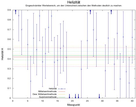
Wir erhalten also für die Helizität mit allen drei Methoden deutlich von Null verschiedene Werte, die sich kaum voneinander unterscheiden. Im folgenden Diagramm wurde die durch die drei Methoden ermittelte Helizität zusammen mit den systematischen und statistischen Fehlern dargestellt:
